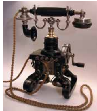
Frühe Telefone wie dieser Skelettapparat hatten keine Wählscheibe, sondern einen Kurbelinduktor, um sich beim „Fräulein vom Amt“ bemerkbar zu machen
