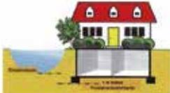
Falsche Bauausführung kann zu Erosion und somit zur Unterspülung der Fundamente führen. Durch den Austrag von Bodenrücken aus dem Bodrigelgefüge kann es zu Hohlräumen im Baugrund kommen, die Gebäudeschäden infolge von Setzungen verursachen.
