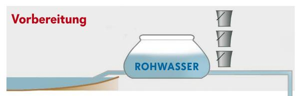
**Verschmutztes Wasser** wird in Rohwasserbecken eingefüllt und mit Chlor, Eisen-III-Chlorid oder Aluminiumsulfat und Aktivkohle versetzt. Damit werden **Bakterien getötet,** Schwebstoffe gebunden und am Beckenboden abgesetzt.
